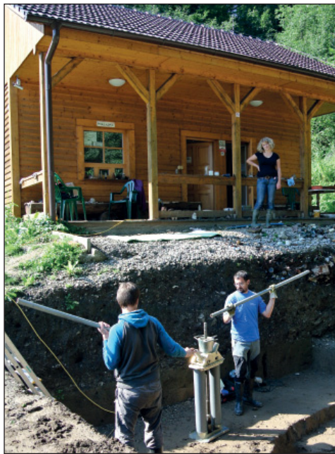
Odebírání geologických vzorků pod budoucím stavenišťem nového vstupního objektu v Archeoparku Chotěbuzi-Podobore, foto Eva Teuerová
